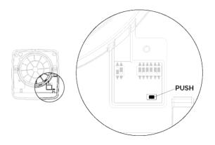
Nach dem Reset muss das Gerät ein akustisches Signal abgeben. Dann muss die Einheit über den Hauptschalter aus- und wieder eingeschaltet werden.
