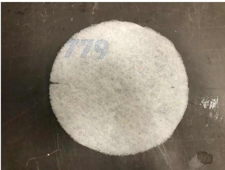
Bild A-7: Filter ISO Coarse 45 % (aussenseitig)
