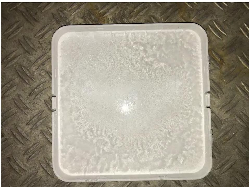
Bild H-2: Innenseite der Außenblende nach Versuchsende
