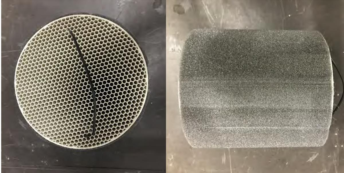
Bild A-10: Vorder- und Seitenansicht des Wärmespeichers
